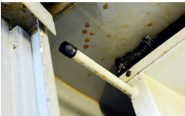
► Ammortizzazione della porta della macchina in un centro di lavorazione
