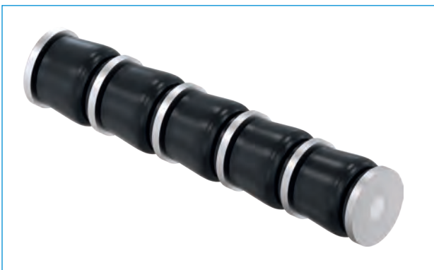
► Collegamento in serie di più BasicStop Axial Standard incl. guida barra tonda integrata per la decelerazione idraulica con forza di supporto ridotta grazie alla corsa più grande
