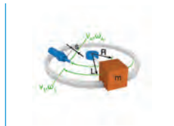
R5. Massa con oscillazione orizzontale senza coppia motrice
