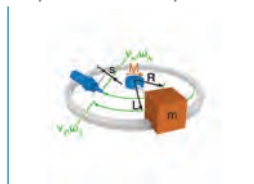
R6. Masse à pivotement horizontal avec couple d'entraînement par liaison mécanique
