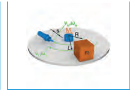
R7. Masse à pivotement horizontal avec couple d'entraînement par friction
